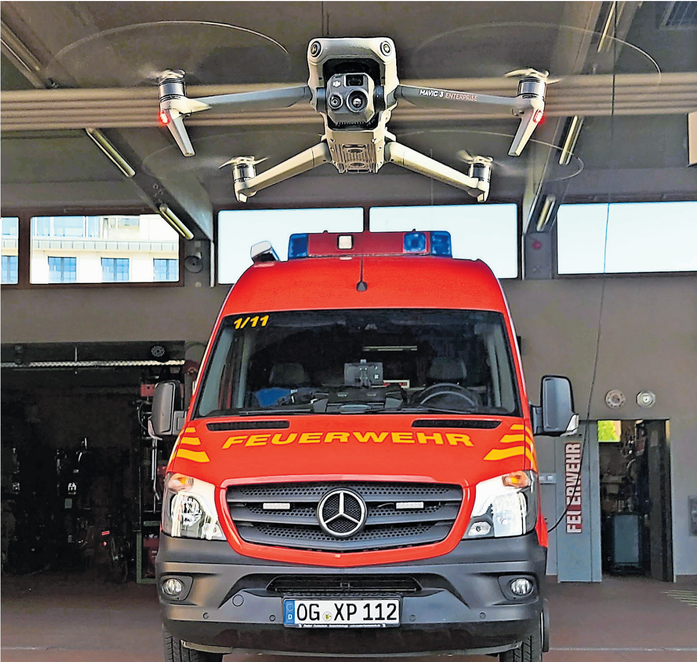
Bei jedem Einsatz dabei: Die „DJI Mavic 3T“ der Feuerwehr hat eine Wärmekamera.
