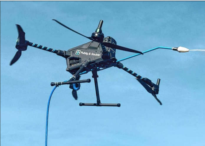
In Zukunft sollen mit der Drohne Fassaden und Dächer ohne Gerüste oder Hubsteiger gereinigt werden können. Foto: M. Shaaban
