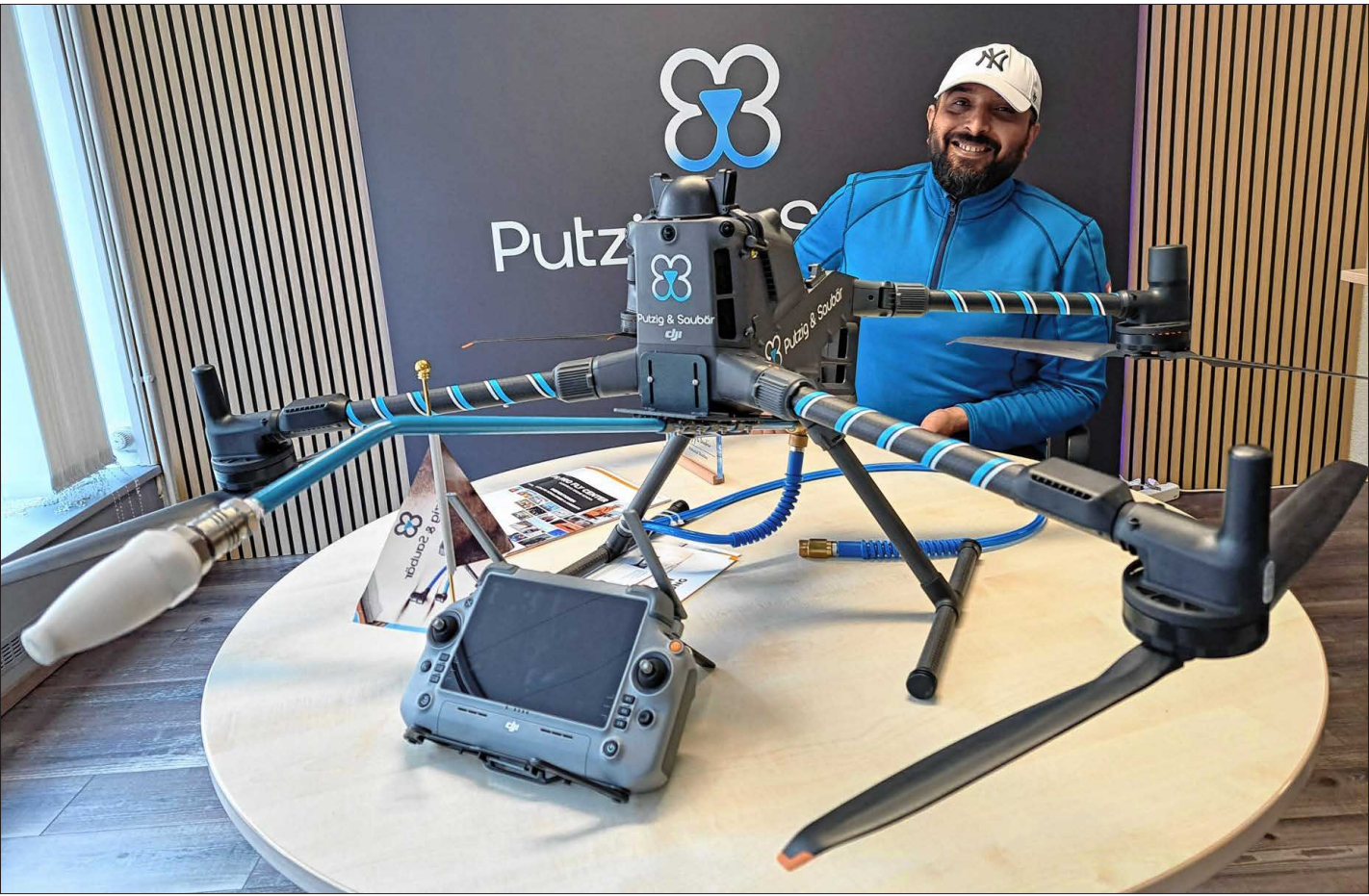
Muhanad Shaaban mit seiner fast 16 Kilogramm schweren Spezialdrohne. Die ist nach dem Umbau unter anderem mit einem Sprühkopf für Reinigungsmittel und Wasser sowie Stickern in der Firmenfarbe und dem Firmenlogo ausgestattet. Foto: Aline Fischer
